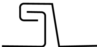
Obrázek B.6 – jednoduchá stojatá drážka ohnutá (úhlová)
