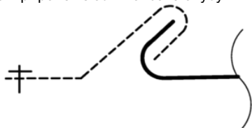
Obrázek A11 – zachycení příponky za koncový ohyb
