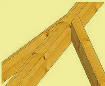
06| Styk krokve na nárožní krokve a) klasické lípnutí
