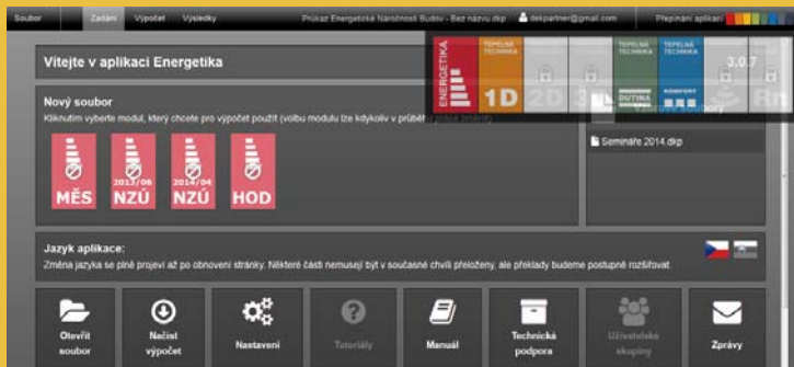
02 | Provázání jednotlivých aplikací DEKSOFT – jediný soubor s koncovkou .dkp. Přepínání mezi aplikacemi v záhlaví aplikací
