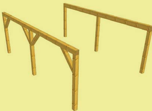
11 | Rozdíl v dimenzích vaznic s podepřením pásky a bez pásků. Dimenze vaznice s pásky 140×200 mm, dimenze vaznice bez pásků v pravo 140×280 mm
